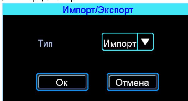
После настройки одного устройства, можно экспортировать настройки на USB диск, затем вставить диск в другое устройство и подать питание на устройство, оно получит настройки предыдущего.
