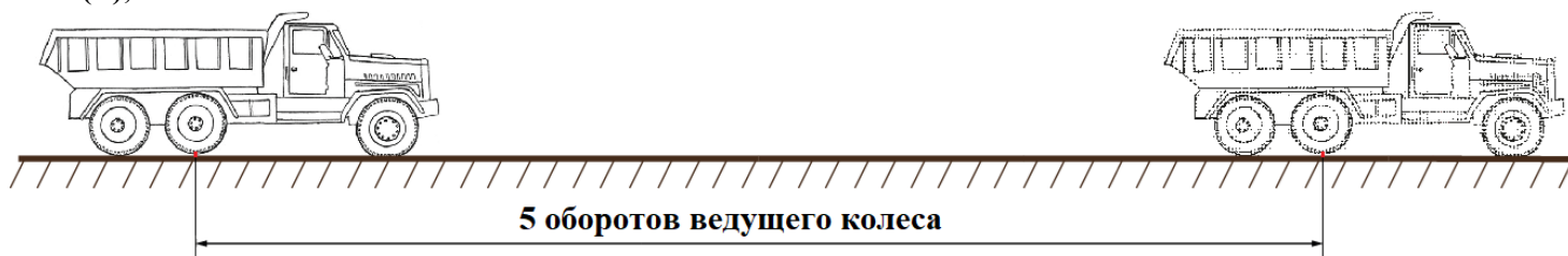
Рисунок 57 – Эмпирическое измерение эффективной окружности шин
