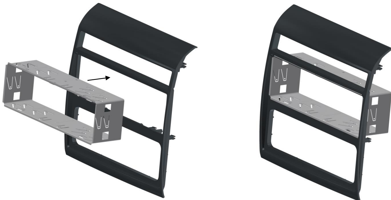
Рисунок 8 – Монтаж установочной рамки тахографа
